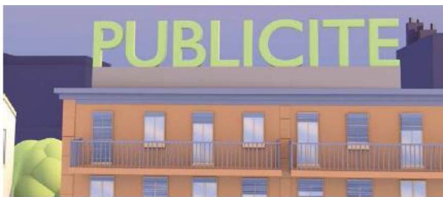
Une publicité lumineuse en toiture doit être composée de lettres découpées sans fixations visibles. Bandeau technique de 0,50 m maximum.
